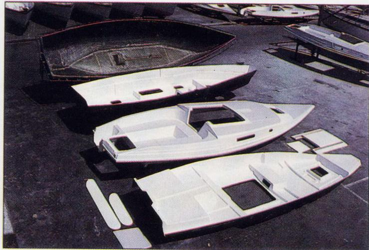
Qui ci sono tutti i componenti della barca. Nella parte alta si vede lo scafo ancora nella forma e qui si può notare il contenitore d'acqua modellato sul fondo dello scafo. Seguono poi il hull liner, quindi il ponte e il deck liner.
