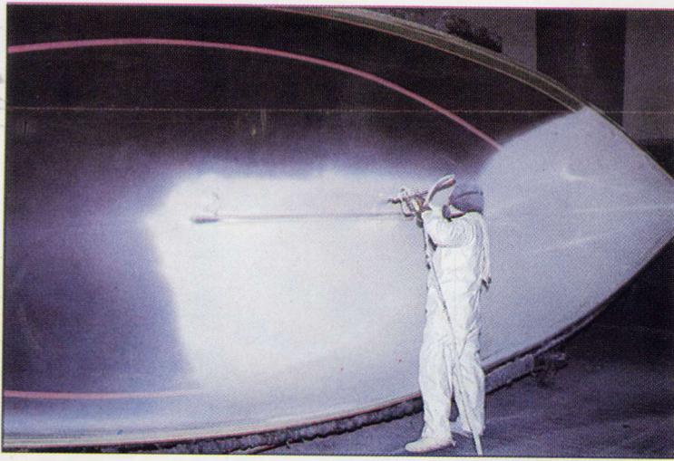
La produzione inizia con la verniciatura a spruzzo della faccia esterna dello scafo su una forma di tre tonnellate già lucidata. La linea di galleggiamento nera e altre strisce sono completate in questa fase della costruzione.
